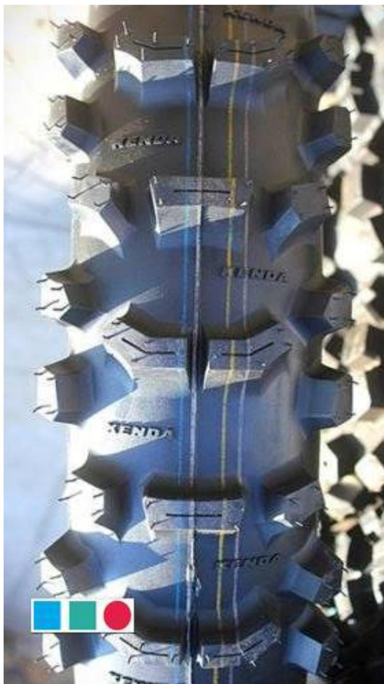
Шина КЕНДА К 782 при резком открытии газа не зарывается вглубь мягкого грунта, а выталкивает мотоцикл вперед. Мне очень понравилась покрышка KENDA K782 Sand-Mad на песчаном треке - позволяет проходить повороты на газу, ехать по глубоким песчаным колеям, перерезать колеи в нужном направлении - везде уверенное сцепление с трассой.
